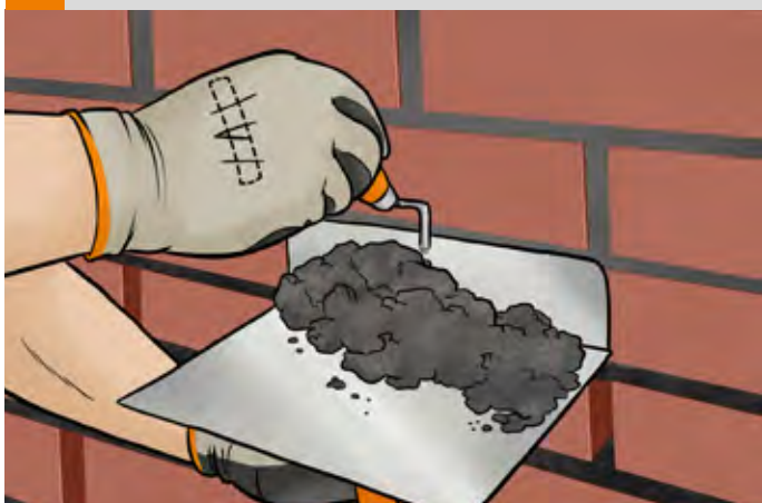
5 Wypełnianie spoin pionowych zaprawą FM T
