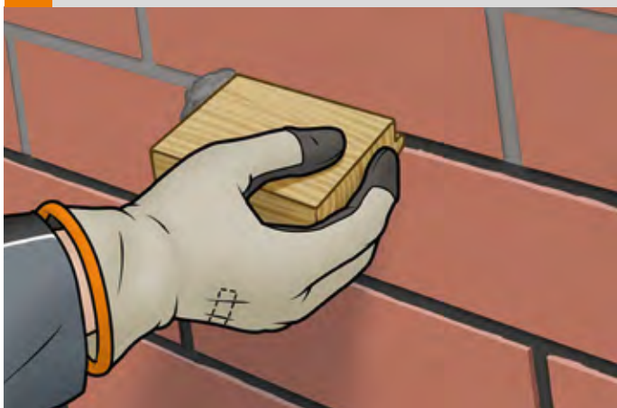
3 Usuwanie zaprawy murarskiej na głębokość ok. 10-15 mm
