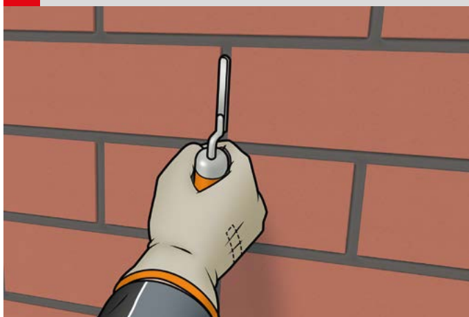
4 Nadawanie kształtu spoinie – spoina prosta
